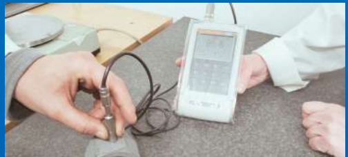
Controllo spessore rivestimenti galvanici
