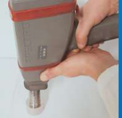
controllo spessore zincatura a caldo
